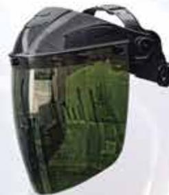
Protege y cubre el rostro de proyecciones de partículas. Visor intercambiable. Cumple con norma ANSI Z87.1 - 2010. Ajuste tipo roller. Está fabricado en policarbonato, material extremadamente liviano, fuerte y resistente a impactos. Este material protege contra los rayos UVA y UVB.
