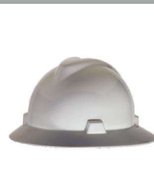
Los cascos de seguridad tipo cachucha MSA V-Gard, consisten en una estructura de polietileno (carcasa) y un sistema de suspensión que juntos crean un sistema de protección. Cumplen y exceden los requisitos aplicables para un casco Tipo I (impacto superior), Diseñados para proveer protección contra impactos (limitada) y penetración a la cabeza de los usuarios, así como a la tensión eléctrica.
