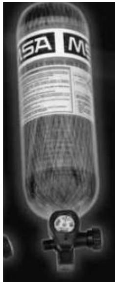
Este equipo cuenta con un cilindro recubierto en fibra de carbón de baja presión (2216 psig) para 30 minutos de duración. Tiene un peso de 18 lb. Se adecua perfectamente para aquellos usuarios que no utilizan un SCBA frecuentemente. Ofrece un tiempo de vida de 15 años.
