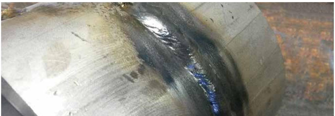
Arco estable y soldaduras regulares en PF(asc.) / posición 5G asc.
