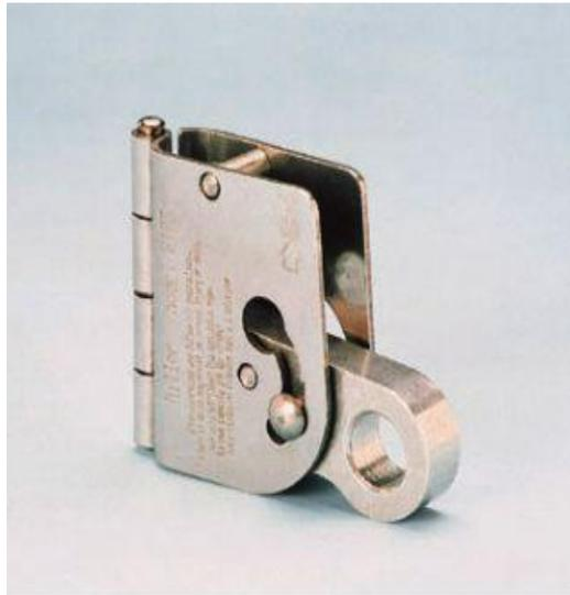
*Los agarra sogas de Miller se mueven fácilmente en líneas de vida verticales hacia arriba y abajo para brindar seguridad continua contra caídas. Los modelos de arrastre ofrecen operación completa de manos libres para incrementar la productividad. En caso de caída.*
