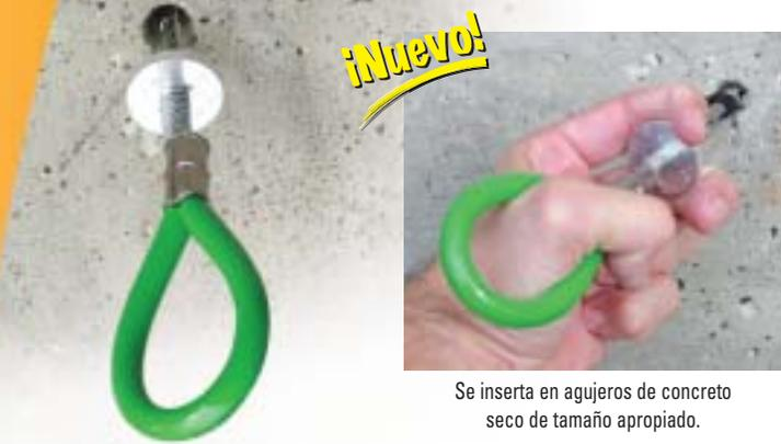
Diseñado para aplicaciones individuales de protección contra caída. Un punto de anclaje seguro de 5,000 libras (2268kg) se establece perforando un agujero de 3/4" de pulgada (19mm) de diámetro en concreto curado e insertando el ancla Titan Grip.
