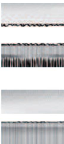
**EXTREMADAMENTE RÁPIDO** - El ángulo de inclinación de las estrías indica una velocidad de corte excesiva. El borde superior es correcto y la cara del corte lisa, sin embargo se adhiere escoria a la parte inferior y existe el peligro de perder el corte. No hay tiempo suficiente para que la escoria sea expulsada fuera de la sangría. La cara de corte es en general levemente cóncava.
