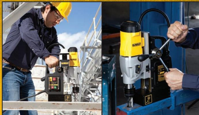
Perforación de chapa de acero hasta 2" en el lugar de la aplicación, vertical y horizontal. Otras aplicaciones: Rimar, Roscar y Avellanar piezas de chapa de acero.
