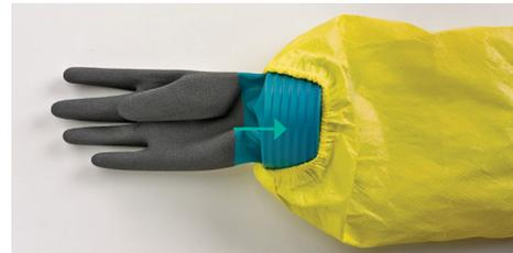
**Paso 3** - introduzca el guante con el cono por la manga y asegúrese de que el cono quede completamente cubierto por la manga, tal como se muestra en la imagen del paso 4. Si la manga es doble, utilice la exterior.
