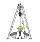
**3** - Coloque el tripode de modo que la línea de vida esté directamente sobre el área de trabajo prevista cuando se instale.
