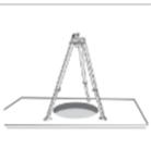
**1** - El tripode debe montarse donde se pueda nivelar usando los ajustes de la pierna.
