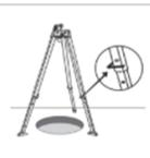
**5** - Las clavijas en las patas del tripode deben estar firmemente bloqueadas para soportar la carga prevista.
