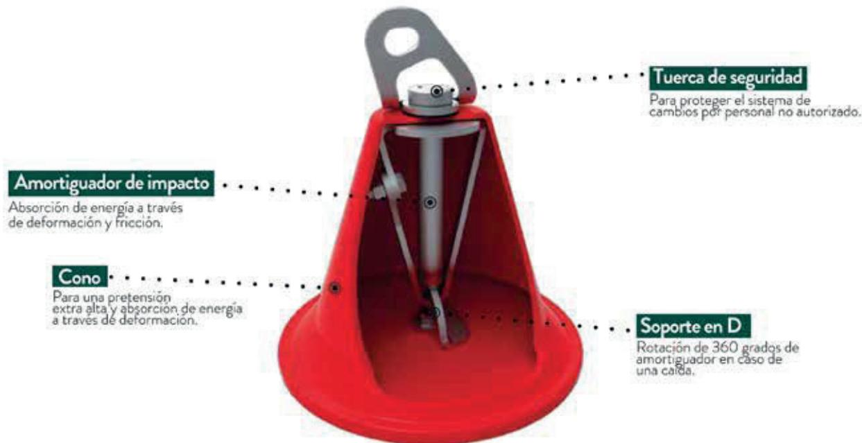
En caso de una caída, los anclajes se deforman absorbiendo energía inmediatamente, cambian de posición para reducir el brazo y evitar amplificación de fuerzas en las estructuras y activan un amortiguador interno para absorber a fuerza de la caída.
