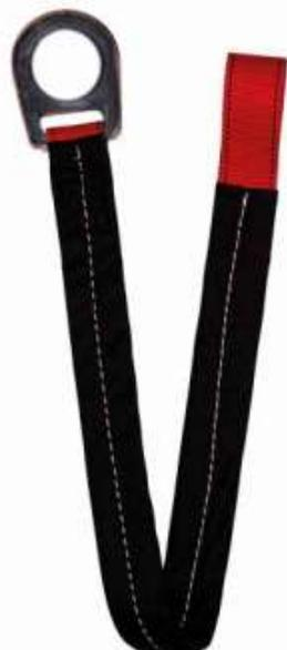
Diseñado como dispositivo de anclaje que conecta de forma segura al amortiguador de impacto o eslinga amortiguadora del trabajador con una estructura de anclaje capaz de resistir hasta 2,268 kgs (5,000 lbs) por trabajador conectado a ella. Este equipo está elaborado bajo estrictos estándares de calidad que ofrece un apropiado funcionamiento al momento de ser utilizado.
